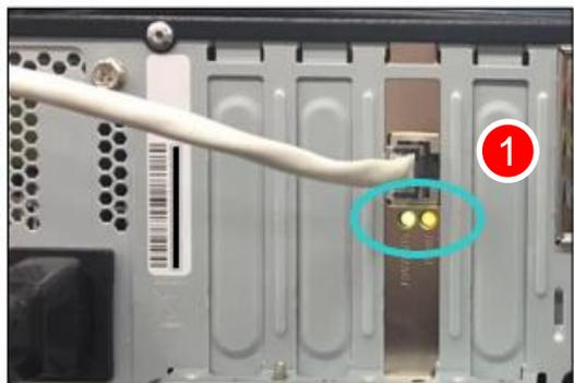
LANケーブルがNAS本体と店内のスイッチングハブから抜けていないか確認し、電源を入れた後、LANポート下、左右どちらかのランプが点滅もしくは点灯するのを確認します。
